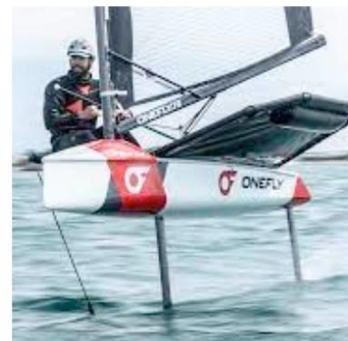
Navigation sur foils au-dessus de l'eau : grâce à la vitesse, le bateau vole...
